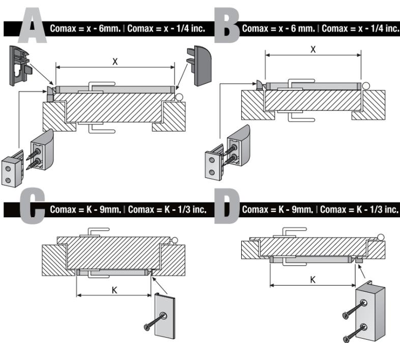
**I** Nei riquadri a fianco sono rappresentate le possibili applicazioni di Comax in funzione al tipo di porta e di telaio. Nei riquadri A e B per porte con singolo battente. Nei riquadri C e D per porte con singolo battente e a 2 o più battenti.
