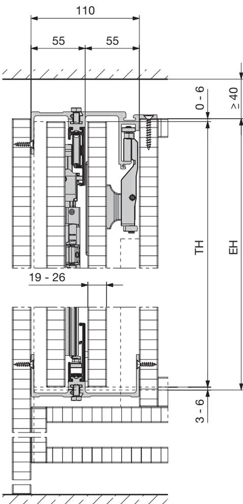
Konstruktionsvariante von der Arbeitsplatte bis zur Decke
